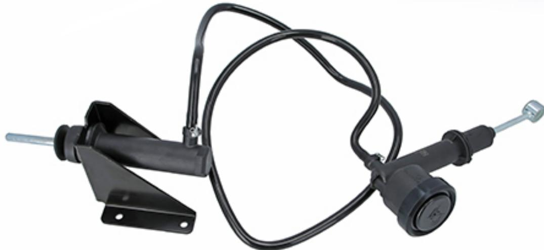
Al accionar el pedal de embrague, el movimiento del pistón ejerce presión para desplazar el cilindro maestro de embrague (bomba principal), el cual pasa a través del tubo hidráulico hasta llegar al cilindro esclavo (bombín). Desde aquí, la presión se transmite para liberar el mecanismo que abre el embrague, lo que, a su vez, interrumpe el flujo de potencia entre el motor y la transmisión.
