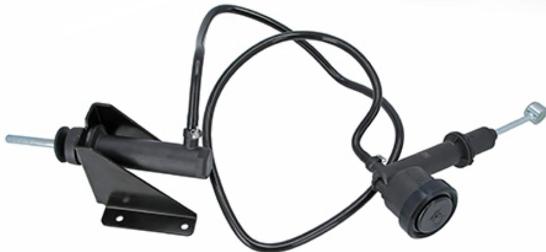
Al accionar el pedal de embrague, el movimiento del pistón ejerce presión para desplazar el cilindro maestro de embrague (bomba principal), el cual pasa a través del tubo hidráulico hasta llegar al cilindro esclavo (bombín). Desde aquí, la presión se transmite para liberar el mecanismo que abre el embrague, lo que, a su vez, interrumpe el flujo de potencia entre el motor y la transmisión.
