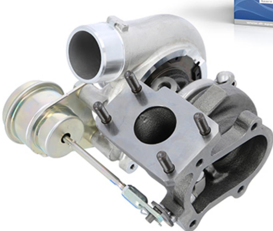
Los turbocompresores se componen de una turbina y un compresor, ambos colocados en un mismo eje coaxial. El compresor succiona aire a presión atmosférica, y rápidamente lo comprime y enfriá mediante el enfriador de aire hasta hacerlo llegar a la cámara de combustión con una presión de 2 bares.
