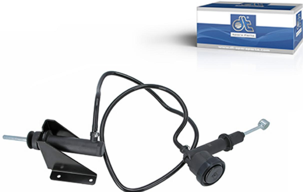
Lorsque la pédale d'embrayage est actionnée, le mouvement du piston provoque une accumulation de pression dans le maître cylindre de l'embrayage, qui passe par la conduite hydraulique vers le cylindre récepteur. De là, la pression est relayée au mécanisme de débrayage, qui ouvre l'embrayage et interrompt ainsi le flux de puissance du moteur à la transmission.
