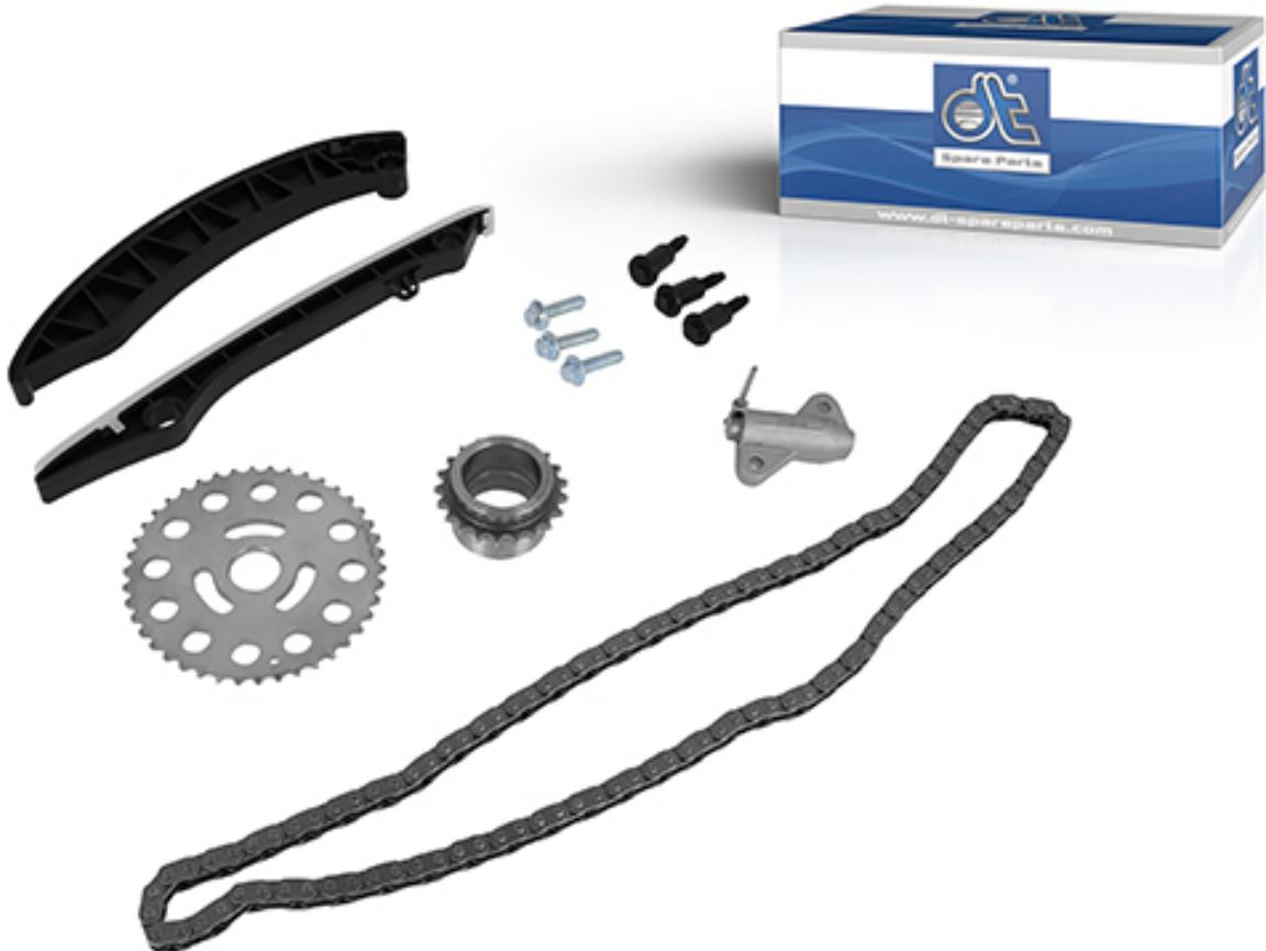
La chaîne de distribution est située à l'avant du moteur et est montée sur deux pignons ; sur le vilebrequin et sur l'arbre à cames. La chaîne de distribution transmet le mouvement rotatif du vilebrequin à l'arbre à cames, ce qui garantit que les soupapes s'ouvrent et se ferment au bon moment.
