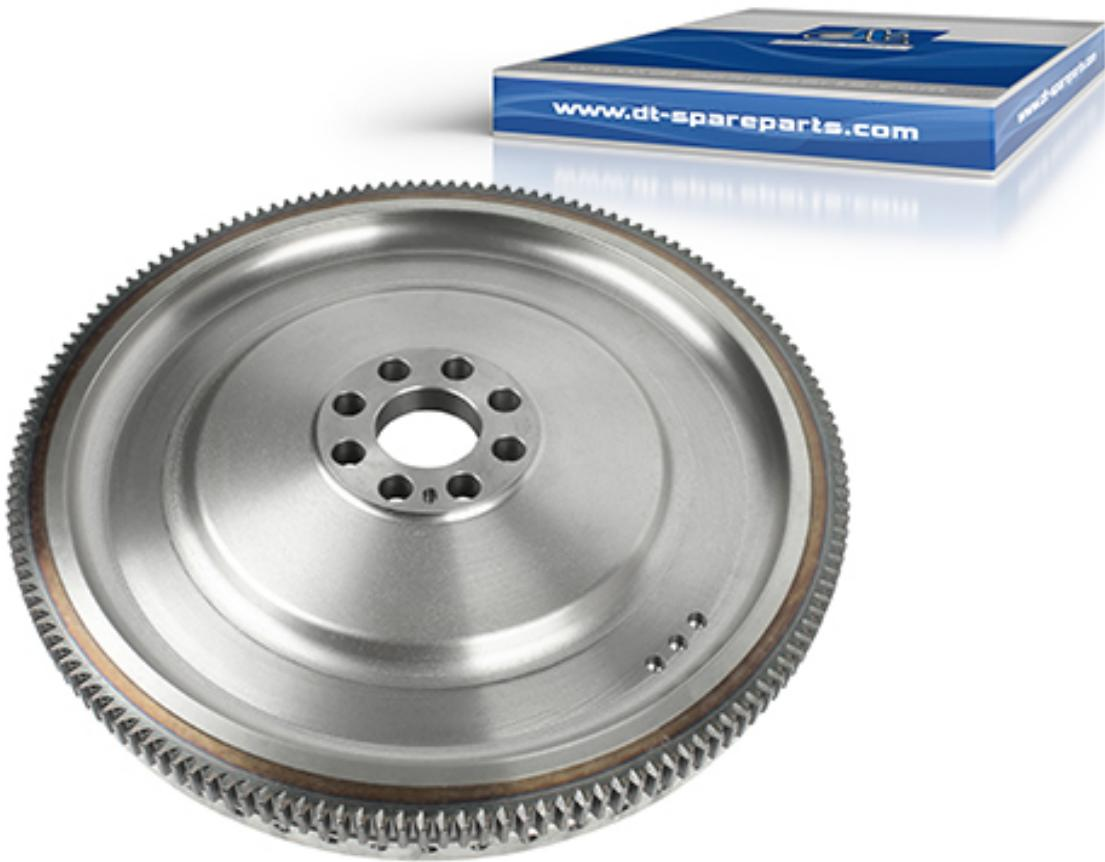
Le volant moteur se trouve sur le côté sortie du vilebrequin. Il établit la connexion entre le moteur et l'embrayage. Le volant moteur réduit les bruits et vibrations du moteur.
