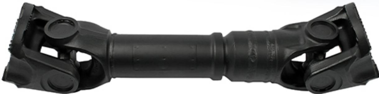
O eixo de transmissão, também conhecido como eixo cardan, é um componente importante na tração traseira e das quatro rodas. Seu trabalho é transferir o torque em um trem de acionamento afivelado do motor ou da unidade de transmissão para o diferencial do eixo. O eixo de acionamento possui juntas universais para que o motor e o eixo não sejam conectados rigidamente, sem suspensão. Assim, garante a mobilidade durante o deslocamento normal e compensa as diferenças de altura.
