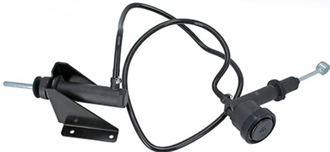
Quando o pedal da embreagem é acionado, o movimento do pistão faz com que a pressão se acumule no cilindro mestre da embreagem, que é passado através da linha hidráulica para o cilindro escravo. A partir daqui, a pressão é retransmitida para o mecanismo de liberação, que abre a embreagem e, assim, interrompe o fluxo de potência do motor para a transmissão.
