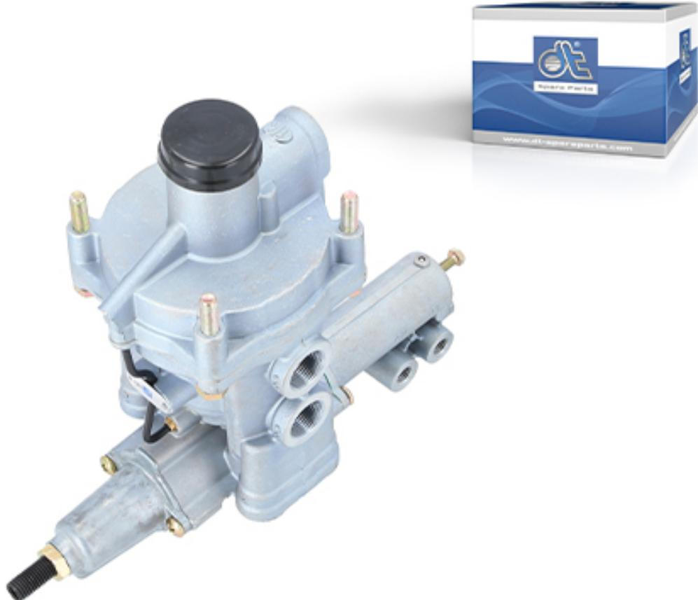
O regulador automático da força de travagem/frenagem dependente da carga tem a tarefa de tornar o efeito de travagem/frenagem de um camião/caminhão dependente da condição de carga do veículo. Os travões/freios são mais aplicados com uma carga pesada e com menos carga, o efeito de travagem/frenagem é reduzido. Isto diminui o desgaste desnecessário e impede que as rodas travem.
