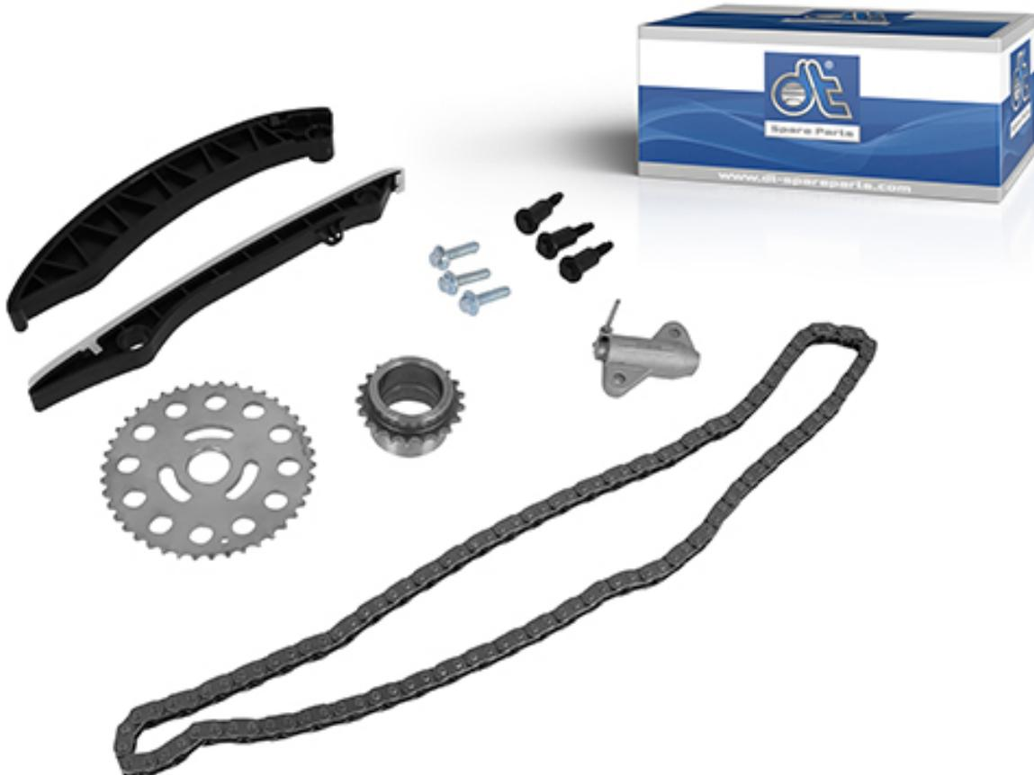
Цепь привода расположена в передней части двигателя. Она установлена на двух звездочках — на коленчатом валу и на распределевале. Через цепь привода передается вращение от коленчатого вала на распределвал, благодаря чему клапаны синхронно открываются и закрываются.
