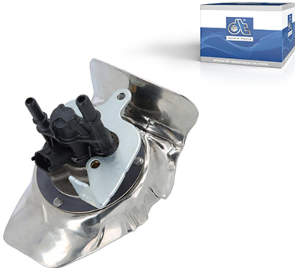
В качестве важного компонента системы очистки выхлопных газов, позволяющей снизить выброс оксидов азота на 90 %, дозирующий блок впрыскивает в систему выхлопных газов в сжатом виде смесь воды и мочевины. Количество впрыскиваемой жидкости зависит от оборотов двигателя и нагрузки транспортного средства.
