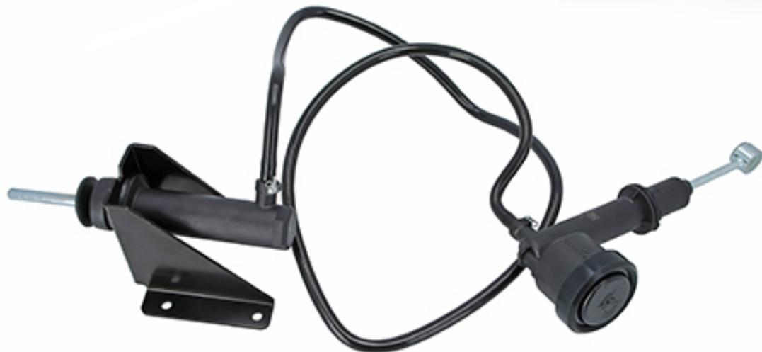
При нажатии на педаль сцепления приведенный в движение поршень создает давление в главном цилиндре сцепления, которое затем передается через гидравлическую линию в рабочий цилиндр. Отсюда давление передается на механизм расцепления, который открывает сцепление и тем самым прерывает передачу мощности от двигателя на трансмиссию.
